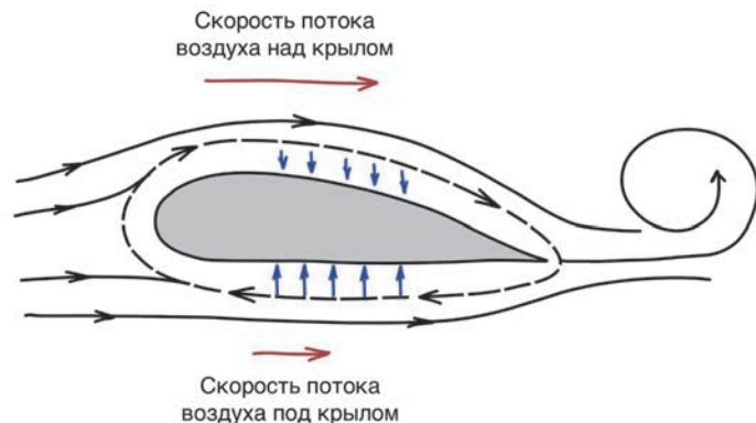
Рис. 2. Поток воздуха, окружающие крыло птицы
